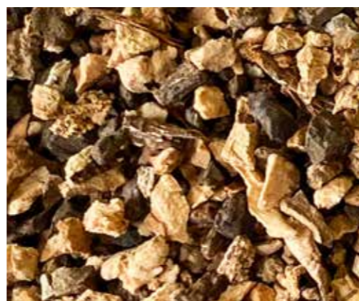
Particules foncées de très mauvaise qualité qui vont créer des désordres en se dégradant prématurément
