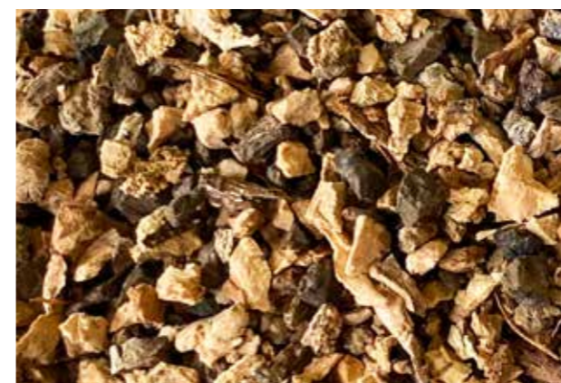
Liège standard avec une densité de plus de 250 gr/litre et un nombre élevé de particules de bois
